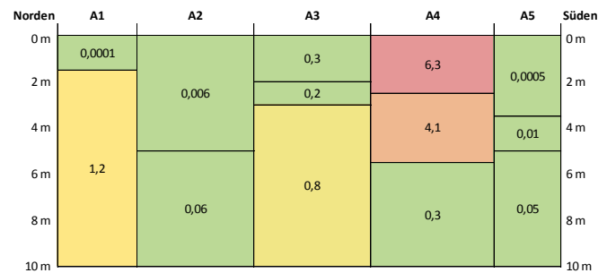
Abb. 6: Fließquerschnitte im Zustrom mit SRP-Frachten in kg/a (Überhöhung 1 : 150)
